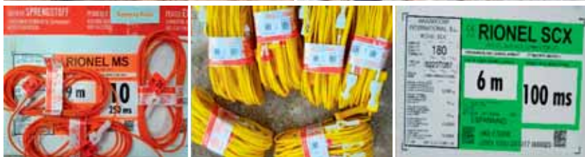
Naranja, carga de fondo. Amarillo, conexión taladros. Etiquetado exterior envases.
